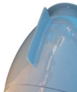
łapa montażowa wentylatora do owiercenia na montażu
