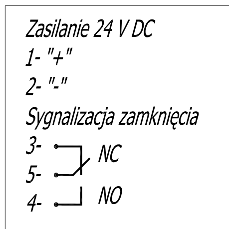
Rysunek 12. Schemat połączenia a) wyłącznika krańcowego MS-C z kostką; b) przewodów do kostki
